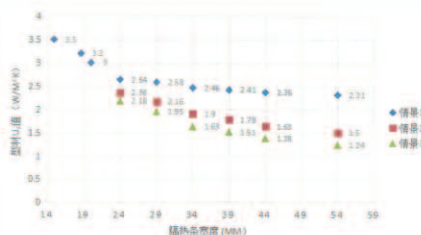
图2 对应隔热条宽度下的型材 U_f 值分布图
